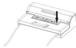
Drücken Sie den vorderen Griff wieder nach oben, öffnen Sie den Deckel und entnehmen Sie den Beutel. Dieser kann nun zum Vakuumieren benutzt werden.
