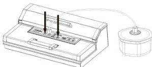
Überprüfen Sie die LED-Zustands-Anzeige für die Vakuumstärke, „normal“ muss ausgewählt sein.
