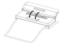
Premere "Sotto vuoto e saldatura" (Vakuum&Schweißen).
