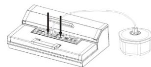
Verwijder de vacuümslang van de aansluiting aan het deksel van de bak en aan het apparaat.
