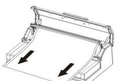
Rollen Sie die Folie auf die von Ihnen gewünschte Länge aus und schneiden Sie sie, mit einem genauen und sauberen Schnitt, auf die gewünschte Länge zu.
