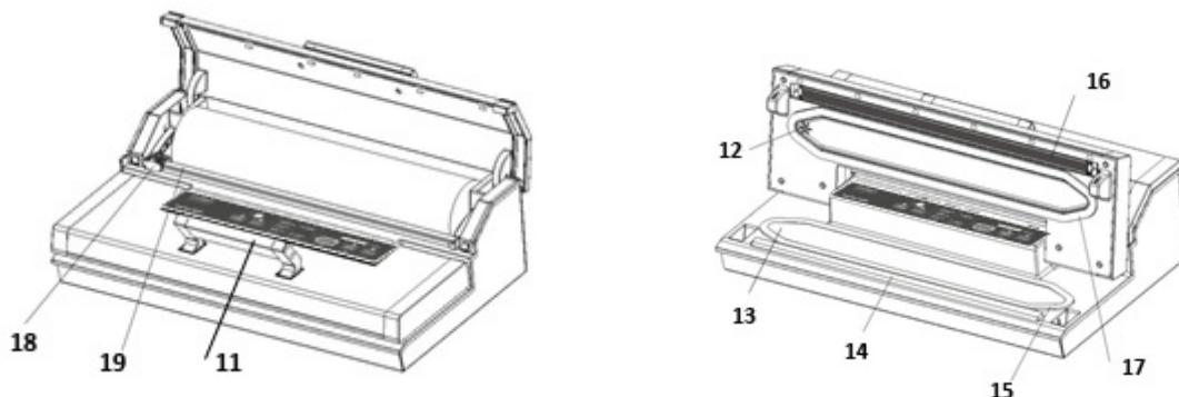
**11 Asa delantera:** Presionar hacia abajo para cerrar la tapa. Levantar para abrir la tapa.
