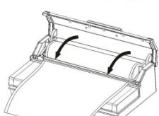
Enrolle la lámina hasta la longitud que desee y córtela hasta la longitud deseada mediante un corte preciso y limpio.
