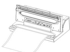
Mettez une extrémité du sachet sur le joint en caoutchouc, mais pas dans la chambre à vide.
